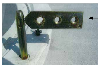
Utilisation du support comme une clef pour débloquer les guides.
